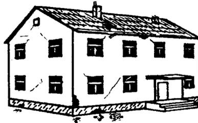
**D2 : dommages modérés** : nombreuses fissures millimétriques et quelques fissures centimétriques dans de nombreux murs, effondrement partiel de cheminée
